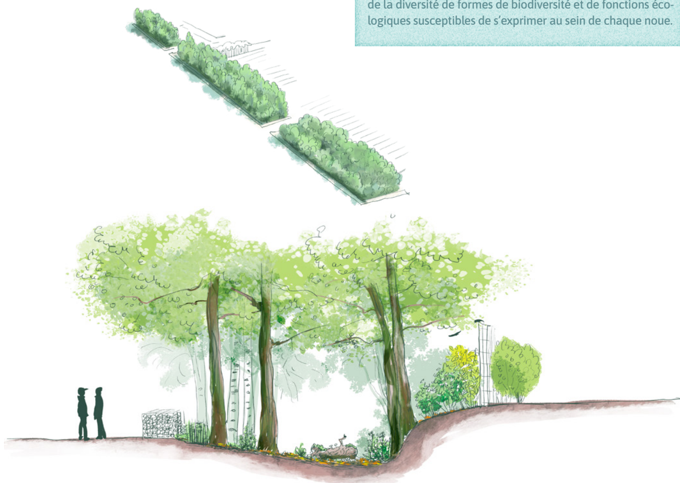
Profil d'une noue boisée délimitée par des gabions le long d'un boulevard au Havre (76). Le maintien du bois mort au creux de la noue forme une litière accueillant une faune du sol diversifiée. En revanche, le sol riche et l'ombrage limitent le fleurissement, ce qui se traduit par une faible présence d'insectes pollinisateurs. / Droits réservés
