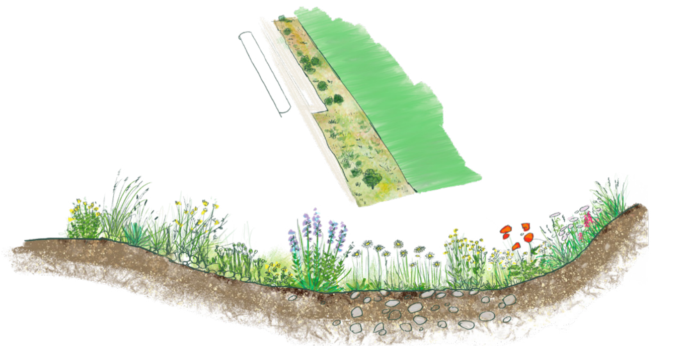
Profil d’une noue située le long d’une zone de stationnement (Saint-Just-Saint-Rambert [42]). Cette noue infiltre la totalité des eaux collectées, sans présenter de zone en eau permanente. Son fond est constitué d’un substrat de nature sableuse et riche en éléments grossiers (galets > 20 cm). Les abords et les parties hautes présentent un substrat de nature sablo-limoneuse et relativement peu structuré. / Droits réservés
