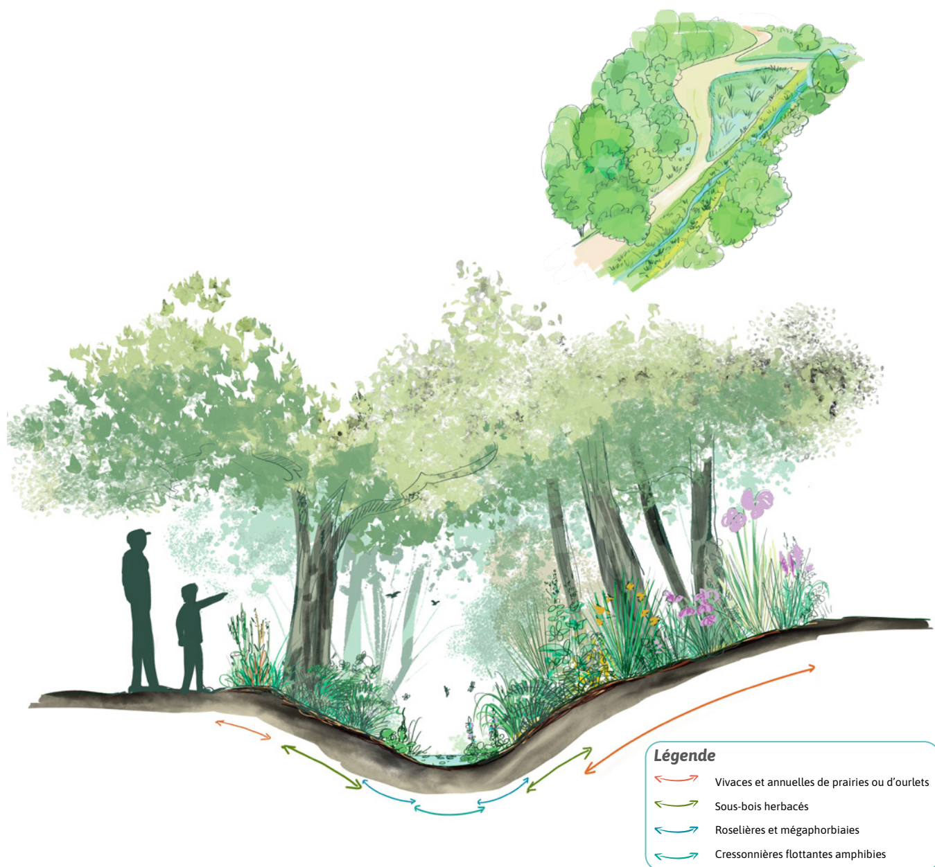
Profil d'une noue arborée, dans le bois de l'Aurore à Antony (92). La végétation est composée d'une strate herbacée spontanée aquatique au centre et prairiale mésophile aux abords, recouverte d'une strate arbustive et arborée de sous-bois frais à mésophile. / Droits réservés
