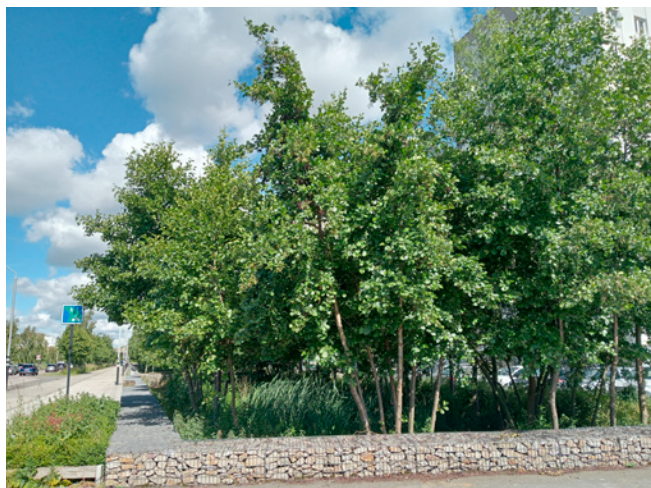
Noue arborée en milieu urbain dense, boulevard de Leningrad, Le Havre (76). La noue stocke et dirige les eaux dans un bassin en aval en cas de fortes pluies. / Maxime Dépinoy, Plante & Cité
