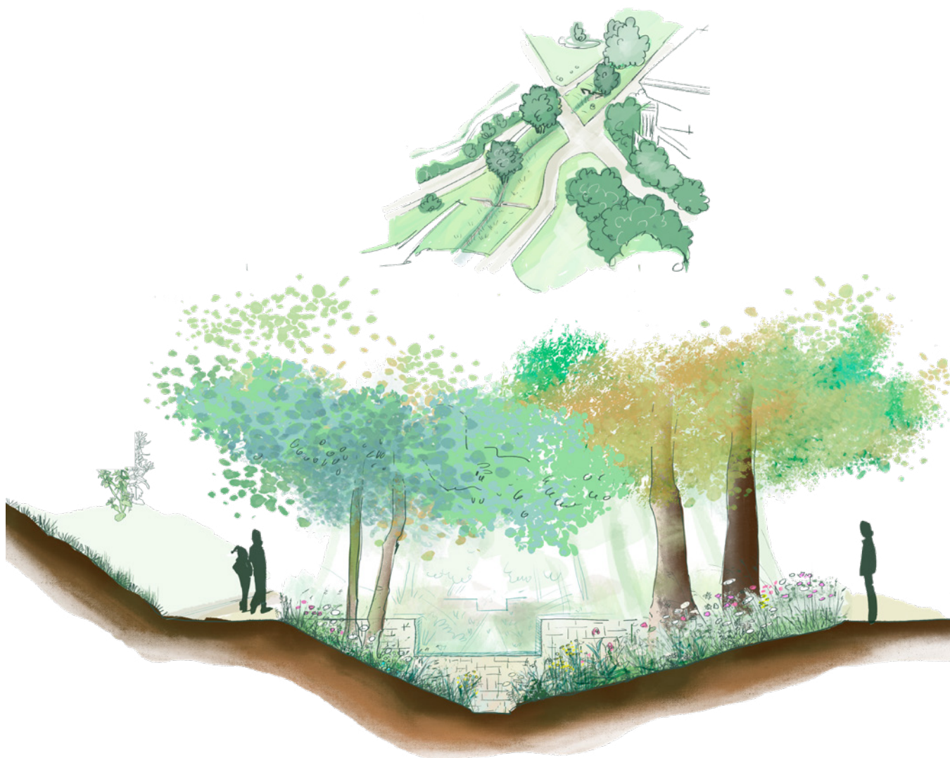
Noue de transfert dans un parc urbain à Nanterre (92), destinée à acheminer les eaux pluviales vers différents bassins d'agrément et de dépollution des eaux. Le fond de celle-ci est équipé d'une rigole en briques cimentées pour permettre à l'eau de ruisseler. Des redans servent à retenir temporairement les excédents d'eau et à ralentir le ruissellement. / Droits réservés
