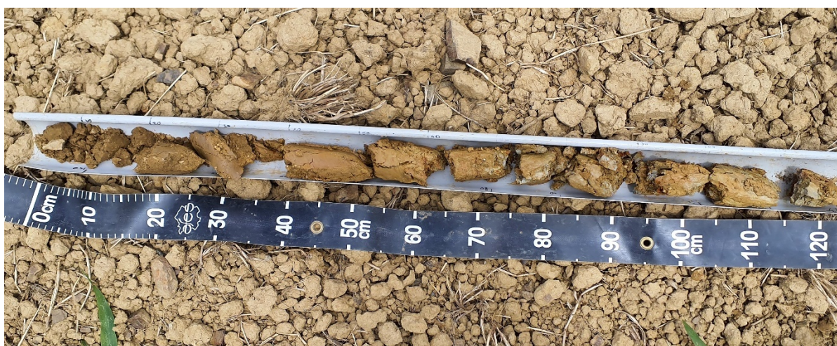
Figure 13. Sondage pédologique à la tarière manuelle (source : Soltis environnement).
