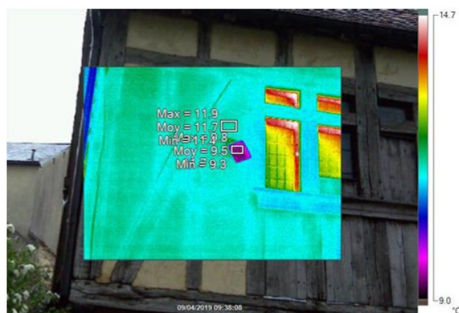
Figure 1 : Mesure thermographique au siège de Maisons Paysannes de l'Oise
