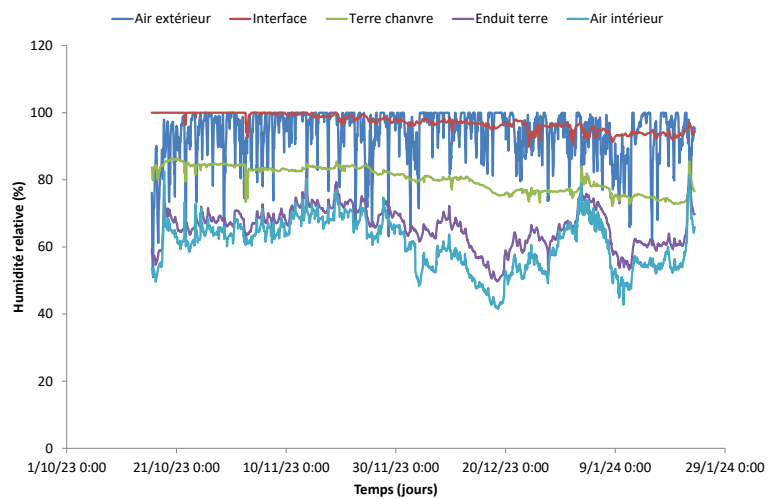
Figure 70 : Évolution de l'humidité relative mur en terre chanvre (octobre à janvier)
