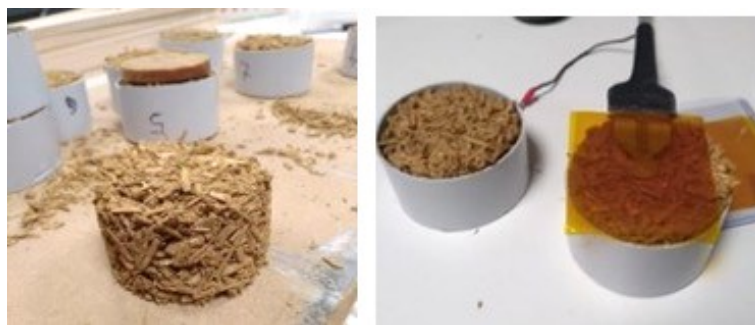
Figure 13 : Dispositif Hot Disk pour la mesure des propriétés thermophysiques de terre-chanvre (LERMAB)
