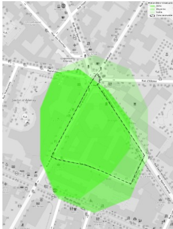
Figure 20. Couverture antennaire (en vert) d'un IRIS (en traits pointillés) du XVème arrondissement de Paris.
