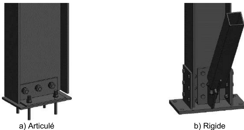
Fig. 4.8 Exemples d'assemblage de pieds de poteau avec poteaux démontables
