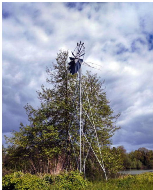
Eolienne installée au bord de la Seine à Nanterre pour alimenter en eau les jardins familiaux. Le vent fait tourner l'hélice de l'éolienne, activant un piston qui pompe l'eau située en profondeur et remplit ainsi un bassin de stockage. Chaque jardin est ensuite irrigué grâce à un canal. © TRIBU
