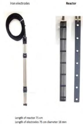
Figure 2 : Electrodes utilisées pour l'EFO
