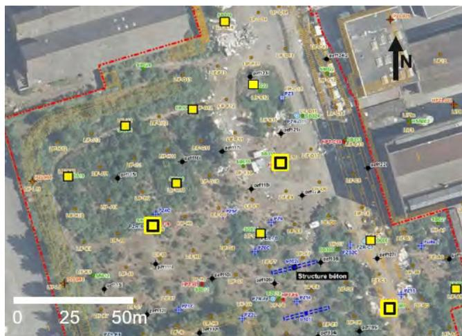
Une répartition des différentes méthodes utilisées sur ce site est représentée Figure 2 : on dispose d'analyses en laboratoire pour tous les sondages, des carottages avec imagerie hyperspectrale (12), des diagraphies HPT/CPT (3) et des diagraphies LIF (9).
