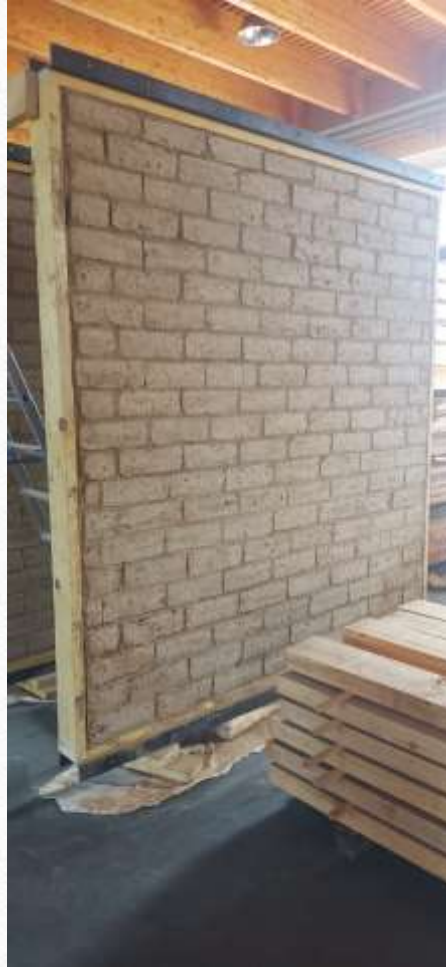
ADOBE remplissage mob essai sismique FCBA pour ZAC Maisonneuve à Guerande (photos CREA Ecoconstruction)
