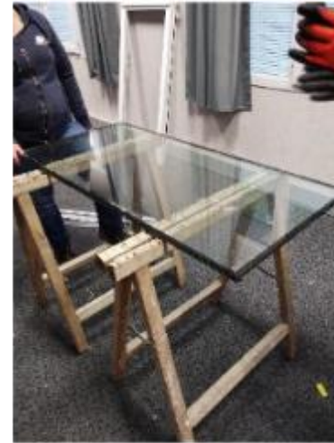
5. Remise en état du vitrage (126x50cm) Pour réemploi in-situ
