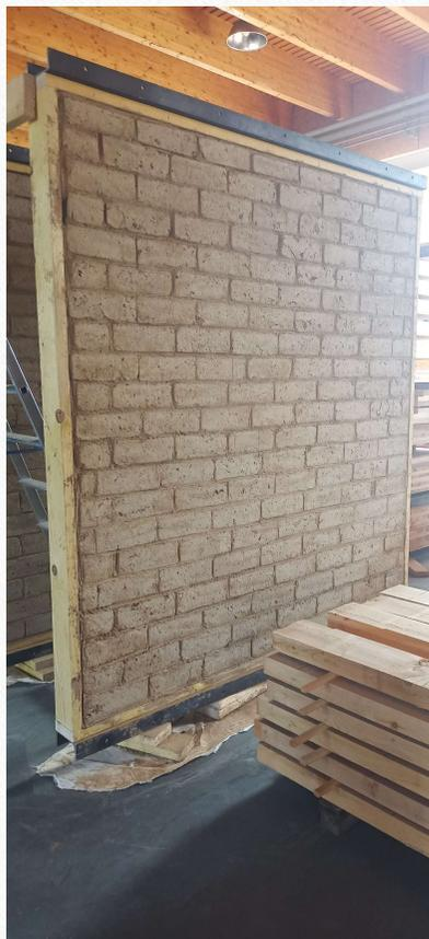
ADOBE remplissage mob essai sismique FCBA pour ZAC Maisonneuve à Guerande (photos CREA Ecoconstruction)
