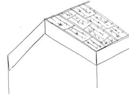
Les bottes peuvent être utilisées en isolation du plafond ou sous les rampants (starking) et sont posées directement sur site ou dans des éléments préfabriqués. Cette étape requiert une vigilance importante en cas d'intempéries et une protection facilement déployable pour protéger les bottes de paille de la pluie.
