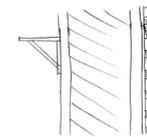
une ossature traversante pourra accueillir un bardage ventilé à l'extérieur et des montants de fixation à l'intérieur, etc...
