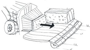
Il est important de savoir quel est le **type de presse** utilisé par l'agriculteur qui fournit les bottes de paille. Aujourd'hui nous sommes dans une période de transition entre 2 modèles de presse : les presses à **canal latéral** (anciennes) et les presses à **canal central** (modernes).
