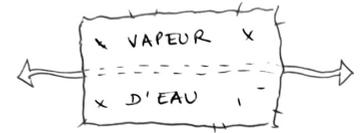
Une paroi perspirante n'est pas une paroi qui laisse passer l'air, elle laisse seulement passer la vapeur d'eau. Il ne faut pas confondre perspiration avec **étanchéité**.
