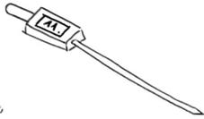
Elle doit afficher une humidité **maximale de 20%**, mesurée avec un humidimètre et ne pas présenter d'odeur ni de trace de pourriture .
