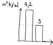
Quand une paroi conventionnelle isolée par l'intérieur présente une résistance thermique de  $3 \text{ m}^2 \cdot \text{K/W}$ , une paroi en paille enduite en terre sur 2 faces en propose  $7,2 \text{ m}^2 \cdot \text{K/W}$  : c'est plus que le double.
