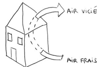
Quelque soit le type de paroi il reste indispensable de prévoir un dispositif pour l'évacuation de l'excès de vapeur d'eau (**ventilation** naturelle ou mécanique).
