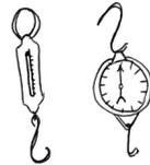
Et une masse volumique **minimale de 80kg/m<sup>3</sup>** et **maximale de 120 kg/m<sup>3</sup>**, au delà les brins s'écrasent. Pour cela un certain nombre de bottes sera pesé au Peson.
