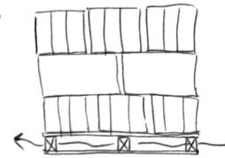
À la réception, les bottes doivent être **stockées à plat** sur une palette pour éviter tout contact avec le sol humide et favoriser la **ventilation** et croisées les unes sur les autres. Il faut veiller à ne pas les **sur-empiler** pour ne pas les déformer par leur propre poids.
