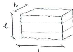
Seules **la densité** et la **longueur** sont des paramètres réglables sur une botteuse. La largeur et la hauteur des bottes dépendent du canal de la botteuse :
