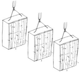
Les structures recevant de la paille peuvent être **préfabriquées** en atelier et transportées sur site avec la paille déjà insérée.
