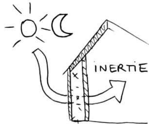
L'inertie est un atout en été lorsque les murs de la maison mettent du temps à se réchauffer ou inversement, en hiver, lorsqu'ils mettent du temps à se refroidir.
